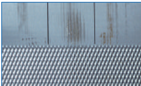
Testovací vzorek znázorňuje odolnost povrchů Rimex s válcovanými vzory vůči poškrábání v porovnání s kartáčovanými hladkými plechy.
